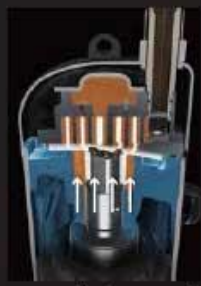
Lực cuộn của đĩa nén động giảm khi hoạt động khi vận hành tải thấp.
