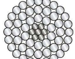
7 sợi thép + 54 sợi nhôm 7 steel wire + 54 Al. wire
