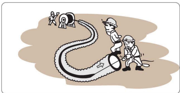
Luồn cáp dễ dàng, có thể bố trí hố ga cách xa nhau hơn Allows easy cable pull in and permits longer distances between handholes
